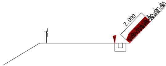
ブロック積み（コンクリート擁壁）石積みの天端より1.00m
